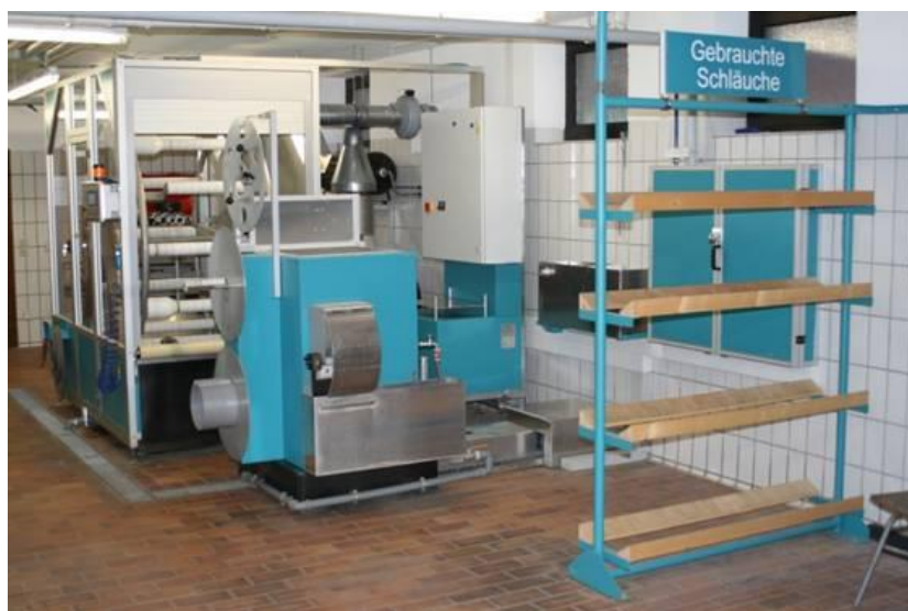
Schlauchwaschanlage der Firma Ziegler
